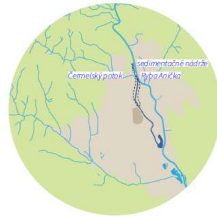
V súčasnosti je voda v MN prívádzaná z Hornádu, čo má za následok zvýšený podiel kolu v koryte. V našom návrhu, voda neprišla priamo z Hornádu, ale je prívádzaná cez navýšené sedimentačné nádrže, Rybu Aničku a z Čermelského potoka.
